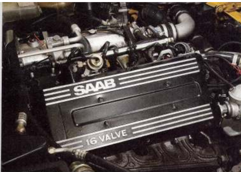
Ein Motor wie ein Vorschlaghammer: Der Turbolader bläst dem Zweiliter 185 PS ein. Dabei kommt der Wummss spät, aber dann in einer Heftigkeit, dass selbst Fahrer moderner Turbodiesel erschrecken
